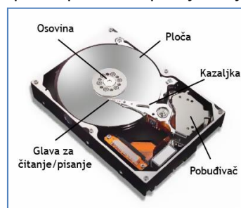
Slika 1-12 Tvrđi disk (hard disk)
