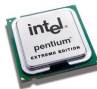
Slika 1-8 Procesor računara (CPU)
