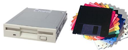
Slika 1-15 Floppy disketna jedinica i floppy diskete
